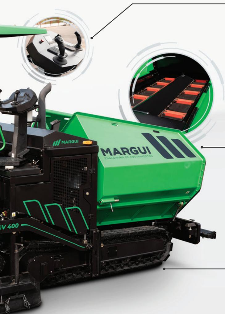
**Silo de Massa** com capacidade de 10 toneladas e design que facilita o escoamento do material.
